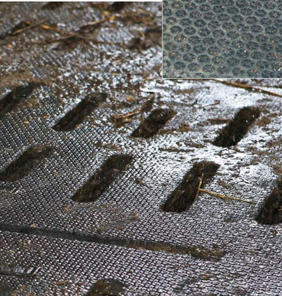
Das bei diesem Prototyp zwei Jahre zuvor von Hand aufgestreuten Korund schimmert Kupferfarben aus dem Gummi hervor.
