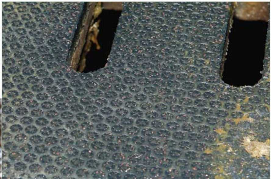
Das bei diesem Prototyp zwei Jahre zuvor von Hand aufgestreuten Korund schimmert Kupferfarben aus dem Gummi hervor.
